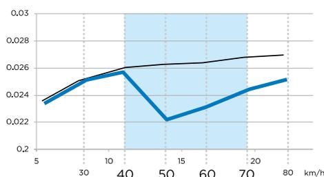
風洞実験や PIV 測定を繰り返し、作られた素材は、レースでの速度域にあたる 40km/h から空気抵抗の軽減効果が加速し、50km/h 付近で空気抵抗の軽減が最大化する (青線がスピードセンサー® II)
