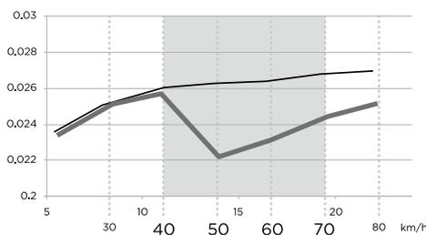
風洞実験や PIV 測定を繰り返し、作られた素材は、レースでの速度域にあたる 40km/h から空気抵抗の軽減効果が加速し、50km/h 付近で空気抵抗の軽減が最大化する (青線がスピードセンサー®Ⅱ)
